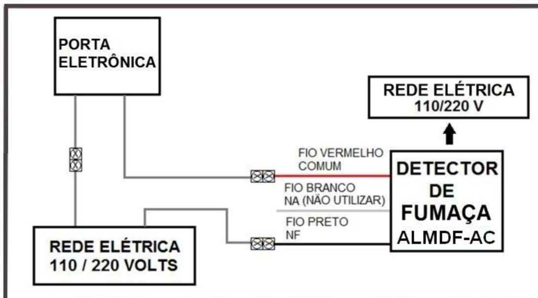
No exemplo acima, quando o detector de fumaça entrar em alarme, automaticamente desenergizará a porta eletrônica, liberando-a de forma que as pessoas possam sair por ela sem correr o risco de se depararem com a porta trancada.
